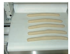
Tapis de sortie sous façonneuse
